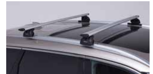
القضبان المتقاطعة قضبان فولاذية مدمجة في قضبان السقف الموجودة. الحد الأقصى للوزن ٧٥ كجم.
